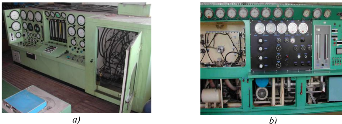
Slika 5. Uređaji za ispitivanje gorivnih agregata, Dawty, model 4400, slika 5a) i uređaj za ispitivanje pumpi ulja, AMS model BEP 1341/B, slika 5b).
